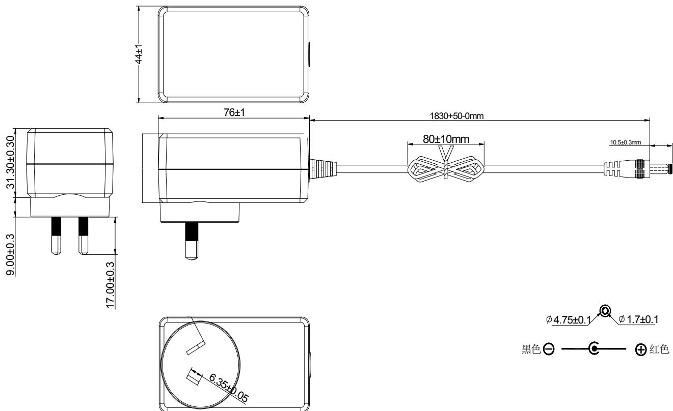
UL2464 20AWG 1.83M 黑色 (BLACK) DC PLUG:  $4.75*1.7*10.5$  mm/180° 直头 音叉车沟 内正外负
